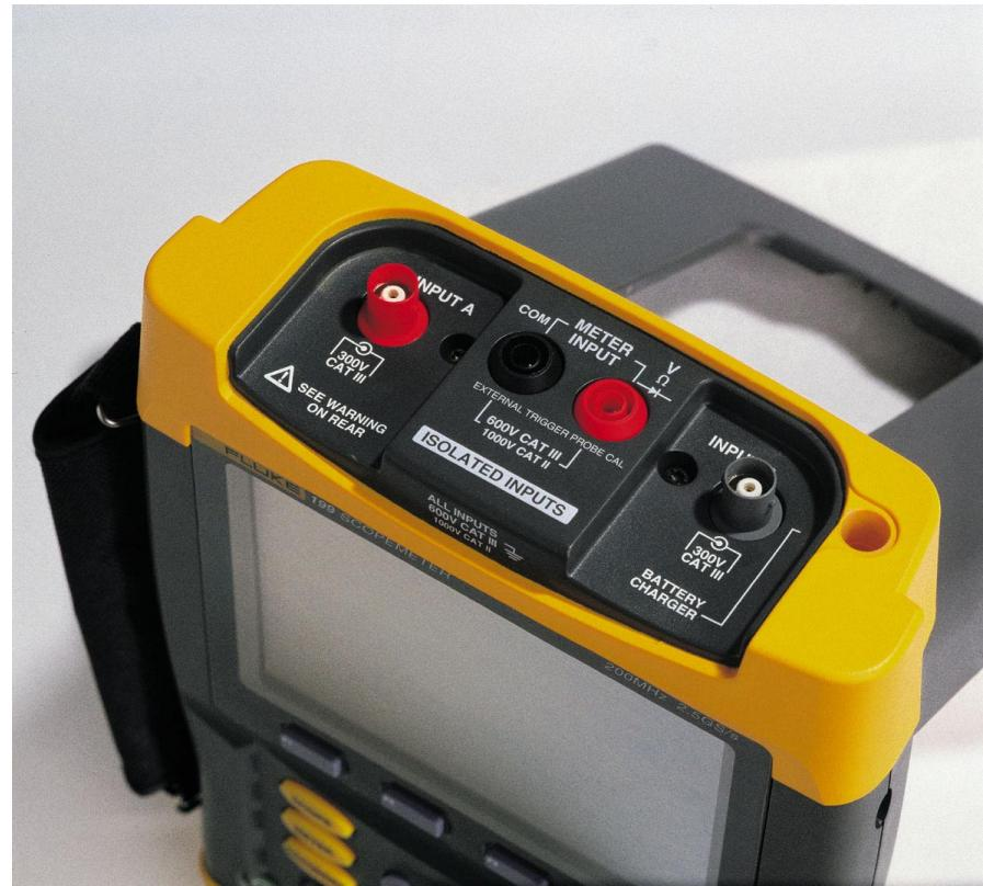
不具备适合工业环境的隔离通道的示波器遇到意料之外或未知的不同接地端是很常见的，这可能会引起短路，在情况严重时，甚至会发生爆炸。即使用户没有遇到未知系统问题，但追求速度和效率这种驱动力也可能会促使产生不安全的工作习惯。经常会发生台式示波器运行时没有接地而使其输入浮置的情况，这种情况会大大增加发生人身伤害甚至电击致死的危险。ScopeMeter 190 中所具有的通道隔离程度可为仪器、正在进行故障排查的设备、您的测试工具以及您自身提供保护。
