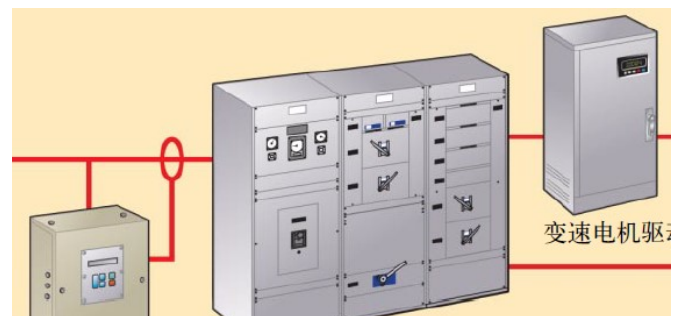
水泵电机配电系统
