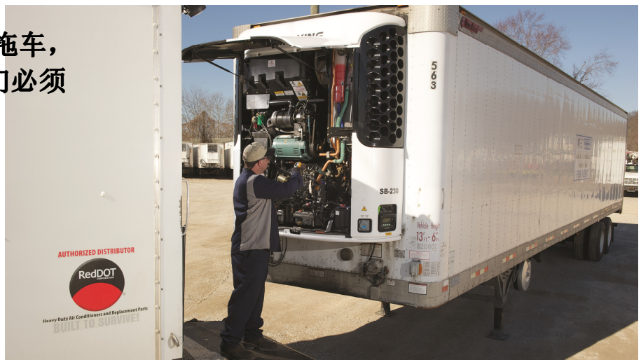
布拉德·麦卡宾利用 Fluke 561 测温仪检查一辆 16 米(53 英尺)长拖车上 Thermo King 制冷机组的工作温度。该项工作的危险/风险等级为 0。
